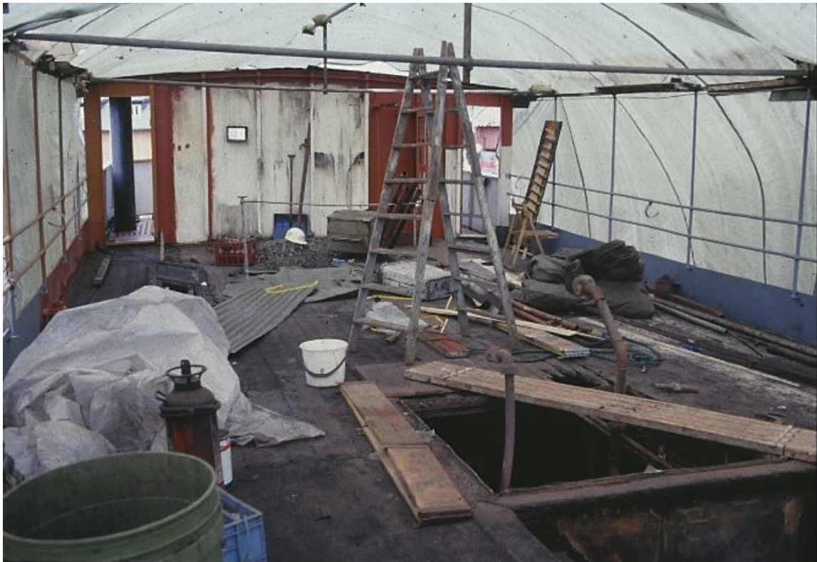
Foto taget kort efter branden 1994 visande bryggdäck efter att främre däckshuset rivits. Däcket, såväl utvändigt som invändigt där däckshuset stått, har en ganska mörk yta och det är utfört med breda svarta nåt. Det framstår som troligt att däcket vid tillfället är fernissat i sin helhet men att ytskiktet smutsats av rök och sot från branden.
