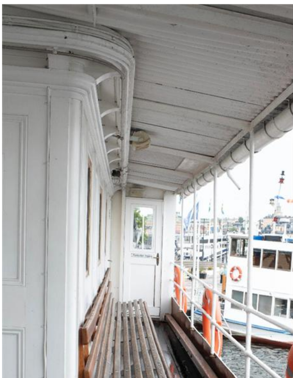
Foto från 2024 av främre däckshus på bryggdäck samt foto från 1963 av aktre däckshus på bryggdäck, visande hur detaljutformningen av takgesimser skiljer sig något mellan nu och då.
