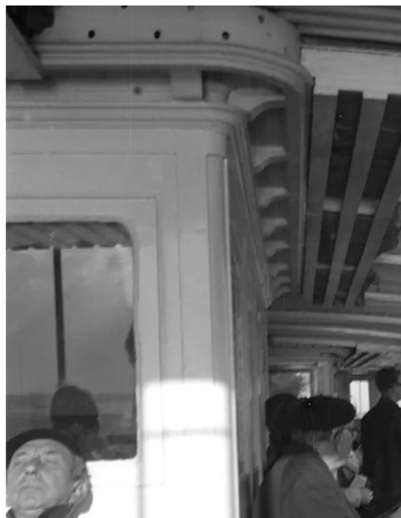
Foto från 2024 av främre däckshus på bryggdäck samt foto från 1963 av aktre däckshus på bryggdäck, visande hur detaljutformningen av takgesimser skiljer sig något mellan nu och då.
