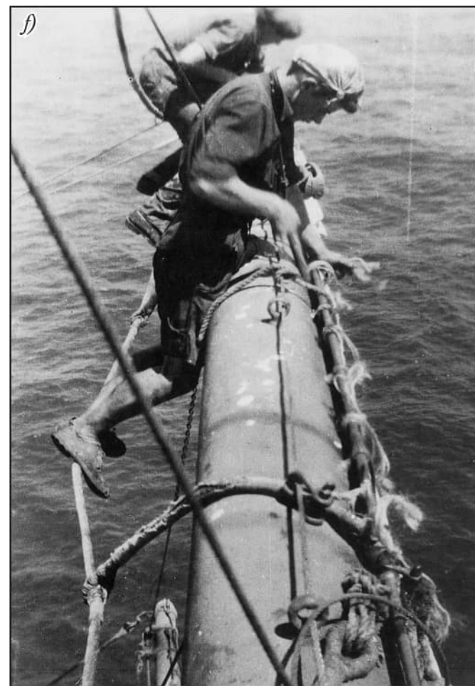
f) Storunderbramseglet bänds till jäckstaget. Fotot är taget under resan till Port Victoria, Australien 1948. Bilder ur VIKING.
